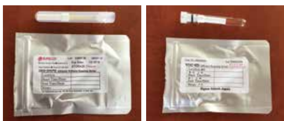
パッシブ法に依るホルムアルデヒドのサンプラー
