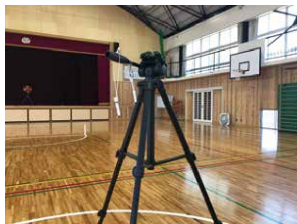
揮発性有機化合物の測定（パッシブ法による空気採取）
