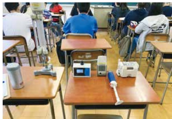
教室の「換気及び保温等」の測定
