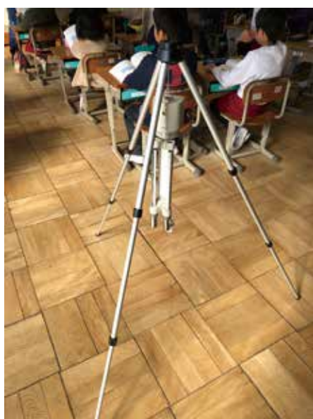
アスマン通風乾湿計による温度相対湿度の測定
