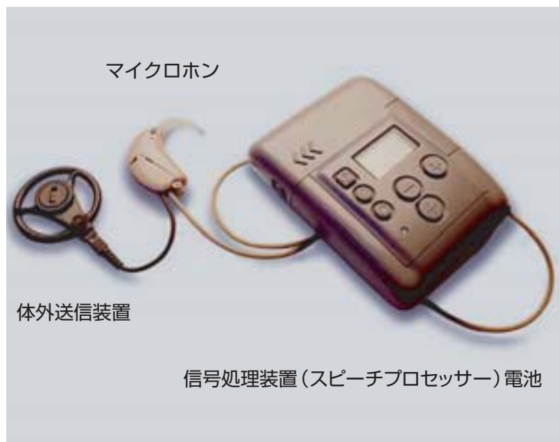
図4-4-3 携帯型人工内耳外部装置（原図日本コクレア社使用許可）
